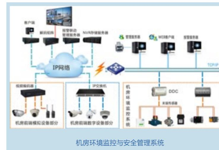
各种规模的数据机房在远程监控、重点监控、环境综合控制等方面提出了专有的运行需求。同方泰德机房综合管理系统集合了消防、门禁、报警、环境综合控制等跨平台专业系统，将触发的报警信号通过报警联动服务器与视频监控系统实时联动，实现各种视频化的报警联动动作，包括报警联动客户端图像弹出、摄像机定位、报警存储、电视墙切换、电子地图提示、信息框提示、报警短消息和报警邮件等，对不同类型机房实现不同侧重的可视化远程监测和运行控制。
